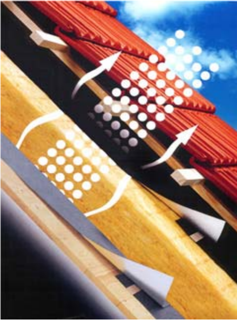
09-Tetto in legno isolato e traspirante
